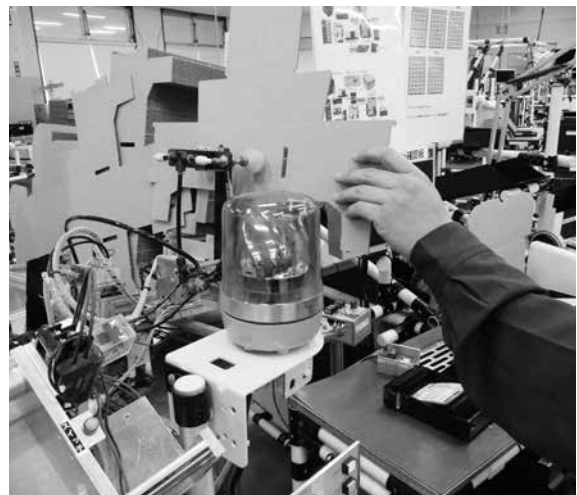
写真1 奥にある段ボールを吸い付けて手前に送る補助具
