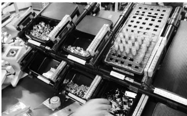
写真5 必要な部品を正確に取り出せるよう工夫した棚
